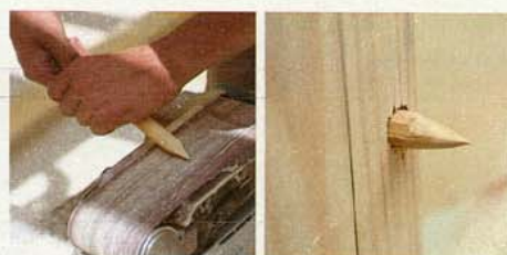
FINALISATION D'UNE CHEVILLE EN BOIS (ICI, LE PONÇAGE), AVANT SA MISE EN PLACE, À DROITE. * ADRESSE EN PAGE 144.
